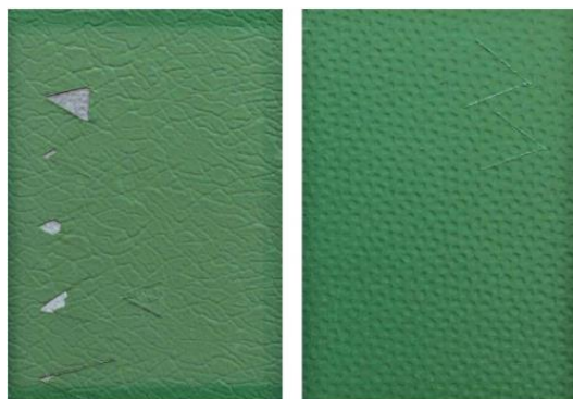
Figura 15: Lacado em cor verde e HPS200 Ultra® após 2000 horas sob radiação UV
