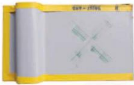
Figura 12 - Foto da amostra de painel com HPS200 Ultra® utilizada no teste de ambientes interiores.
