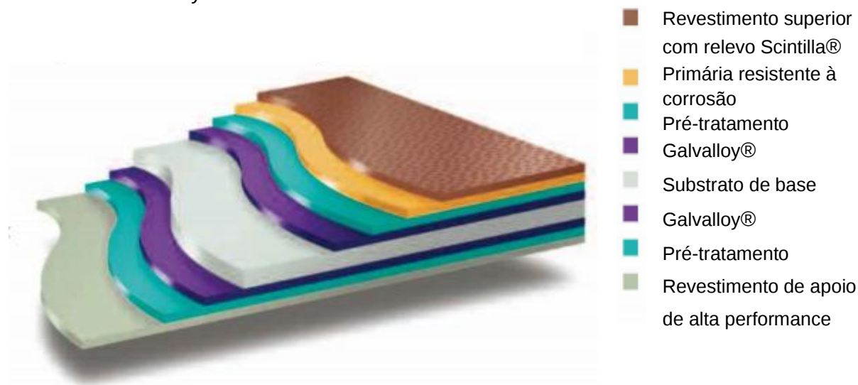
Painel com 7 anos- revestimento HPS200 Ultra® com Galvalloy®
