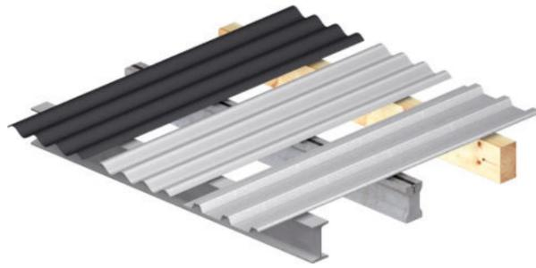
Cubierta con chapa doble perfilada
